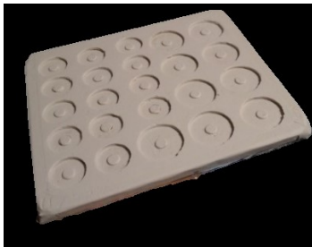
Ilustración 38: Molde 1 en Caucho-Silicona (C-S)
