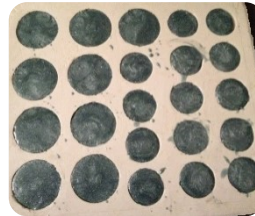
Ilustración 41: Molde C-S con resina poliéster azul metalizada
