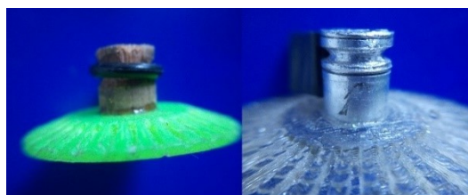
Ilustración 46: Ejes en madera y aluminio, superficies impresas en 3D y fundidas en resina poliéster
