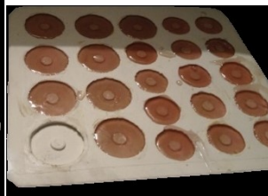
Ilustración 39: Molde C-S con resina poliéster translúcida
