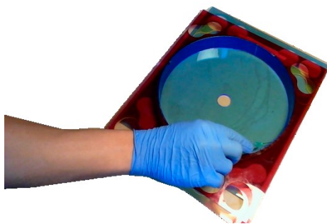
Ilustración 64: Proceso de conformación Empaque por unión química con cloruro de metil-metacrilato
