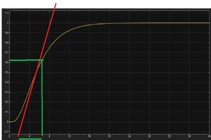
Figura 6.8. Determinación de T_u , T_g y K_s de la respuesta de la planta a lazo abierto.
