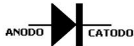
Identificación de patillas en el diodo rectificador
