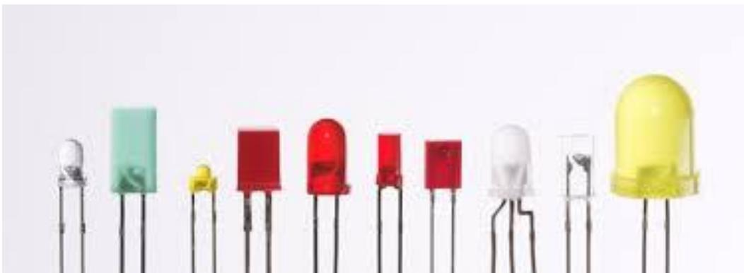
A diferencia del led convencional, el diodo led al conducir consume voltaje dependiendo de su tamaño desde 1,5v hasta mayores voltajes. Este diodo no está diseñado para soportar voltajes inversos y su tensión de ruptura en inverso es mucho más pequeña que en diodo convencional.
