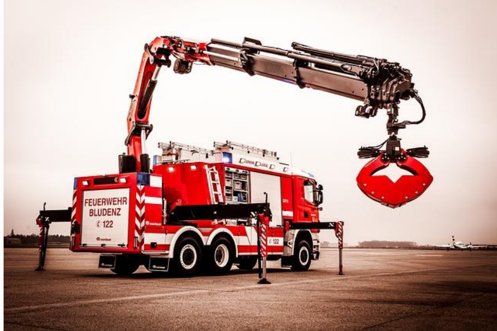
Camión de bomberos con grúa y apoyos extensibles.
